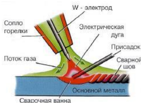
2 Сурет – Аргондоғалы пісіруде жандырғы мен қосымды шыбықтың орналасуы
